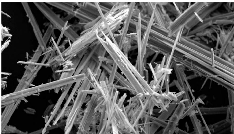
Fig.1 Fibre di amianto al microscopio
